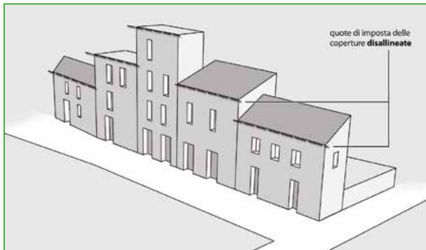
Figura AS 16. Regolarità strutturale - Disallineamento tra quote di copertura dell'AS.
