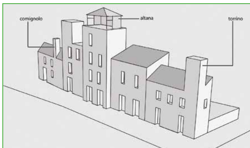
Figura AS 24. Ulteriori elementi di vulnerabilità - Sopraelevazioni, altane, torrini.
