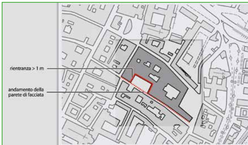
Figura AS 18. Regolarità strutturale - Disallineamento pareti di facciata.
