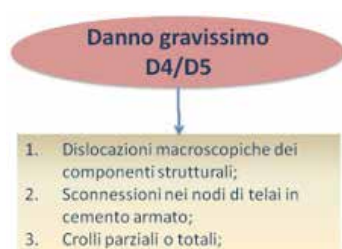
Figura 17. Caratteristiche danno gravissimo D4-D5.
